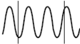
振幅游標。這些水平游標會量測垂直振幅參數，通常指電壓。
