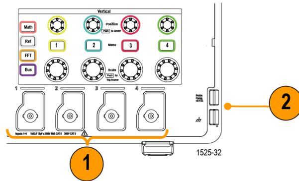
2. **探棒補償**。用來補償探棒的方波訊號來源和接地連接。
