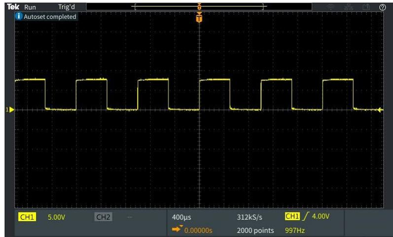
7. 檢查所顯示波形的形狀，判斷是否需要調整探棒。如果波形具有方形前緣，以及平整的頂端和底端，則不需要調整探棒。
