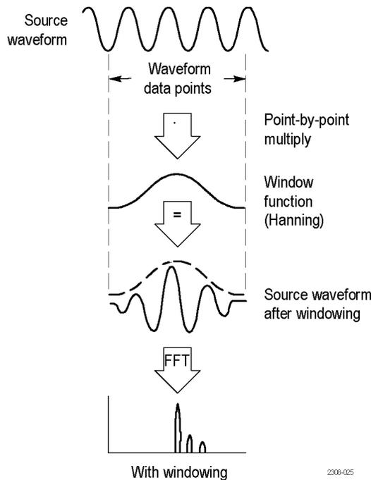
不同的視窗形狀是頻率精確性與振幅精確性之間的取捨。您要量測的目標以及信號源訊號特性，將協助您選取要使用哪個視窗。請使用以下指導方針，為您的訊號分析需求選取最佳視窗。「Hanning」視窗是 FFT 量測的適當起始點。
