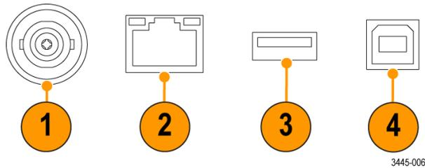
3. **USB 2.0 主要埠**。標準 USB 主機連接埠，可讓您連接 USB Wi-Fi 收發兩用儀轉接器 (硬體鎖) 以進行無線連接 (Tektronix TBS2000B 系列專屬功能)，或連接至 USB 磁碟，藉以儲存或叫出波形、設定、螢幕影像，以及 Courseware 教育套件。
