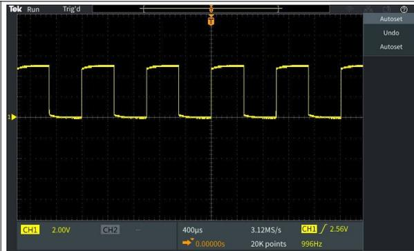
如果顯示的方波頂端不平整，請執行下列程序來補償探棒高頻率響應。您可在完成此功能檢查后補償探棒。請參閱補償被動電壓探棒在頁面上 27。
