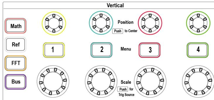
垂直控制項可設定每個通道的垂直設定 (位置和刻度)，以及啟用開啟或關閉個別波形。
