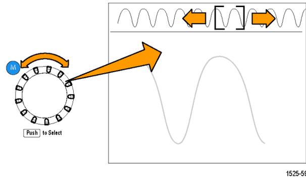
順時針旋轉「Multipurpose」(多功能) 旋鈕，可向前移動。逆時針旋轉，可向後移動。旋轉旋鈕越多，縮放視窗移動速度就會越快。
