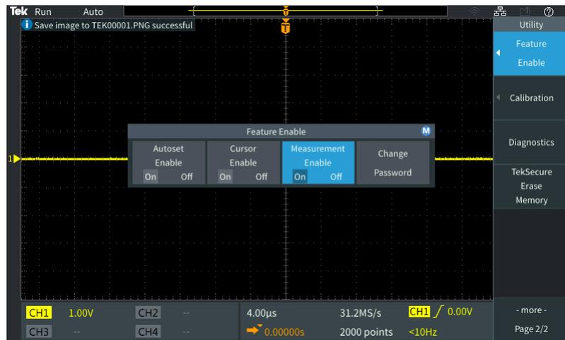
5. 使用「Multipurpose」（多功能）旋鈕和側邊功能表按鈕，來輸入可讓您停用「Measurement」（量測）的密碼。
