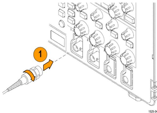
3. 將探棒頭和接地引線連接至示波器上的 **PROBE COMP** 接頭。探棒頭連接至 5 V 接頭，而地線夾連接至接地接頭。
