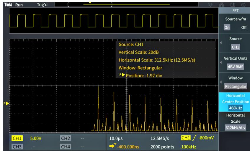
8. 按下「**Horizontal Scale**」(水平刻度)側邊功能表按鈕,並使用「**Multipurpose**」(多功能)旋鈕來設定水平刻度(每個主要方格圖格的頻率)值。請使用下列程序,來展開或縮小 FFT 波形,以顯示更多或更少詳細資訊。FFT 波形會圍繞中心游標展開。
