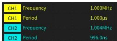
如果垂直截波狀況存在, 則
