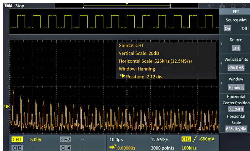
3. 按下「**Source wfm**」(來源波形) 側邊功能表按鈕，來切換「**On**」(開啟) 或「**Off**」(關閉) 顯示來源波形 (位於螢幕頂端)。
