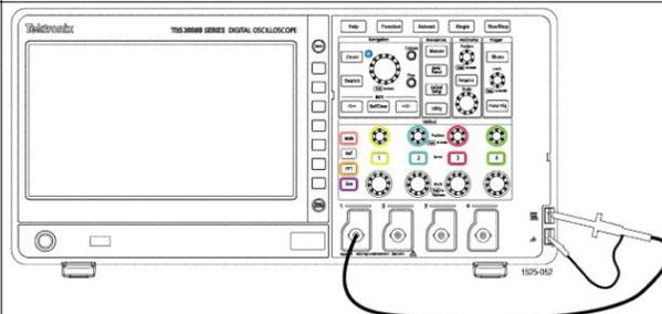
按下「**Default Setup**」(預設設定)。預設設定可將示波器設定回復為原廠預設值。請參閱 [預設示波器設定](#) 預設設定在頁面上184。
