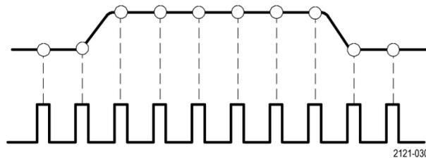
TBS2000B 系列示波器使用即時取樣。在即時取樣中，示波器會一次並依順序取樣並數位化所有取樣點、將取樣資料儲存在記憶體中，然後重複取樣和儲存程序。
