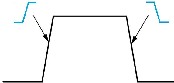
觸發臨界值「**Level**」(位準)(或僅稱位準)是斜率上的訊號振幅值，這必須發生，示波器才能在訊號上觸發。
