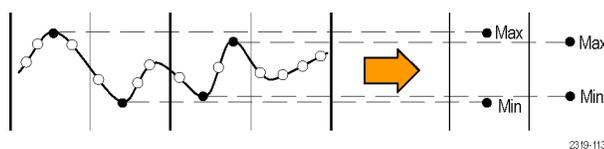
「**Hi Res**」(高解析度) 模式會補償較低頻率訊號，並計算每個擷取間隔的所有樣本平均值。使用高解析度模式，可為較低頻率波形提供更高解析度 (16 位元) 取樣點。
